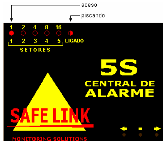
Figura 1.j – central indicando tempo do setor temporizado em 15 segundos.
