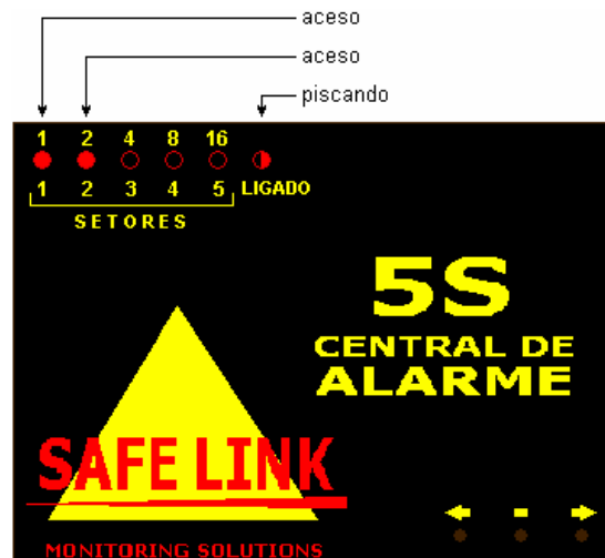
Figura 1.d – central indicando 3 segundos (1 + 2 acesos = 3).
