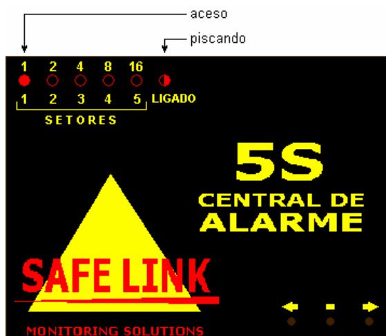
Figura 1.n – central indicando, o valor do SEGUNDO CAMPO é “1”.
