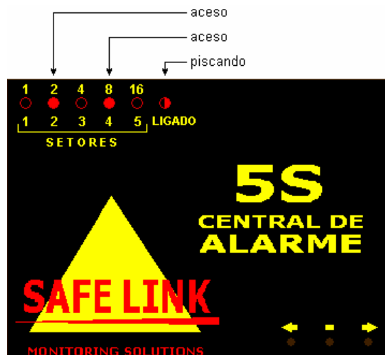
Figura 1.t – central indicando, no CAMPO depois do último dígito do telefone, o valor de 10 (2 + 8 acesos = 10) para finalizar a programação do telefone.
