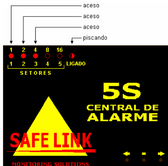
Figura 1.u – central indicando que está no ENDEREÇO 7 (1 + 2 + 4 acesos = 7).
