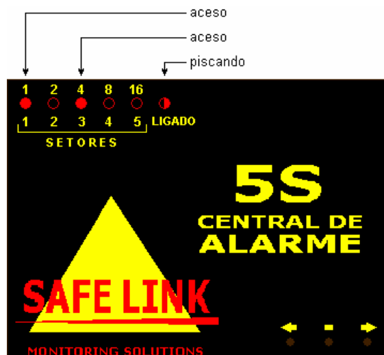
Figura 1.l – central indicando que está no ENDEREÇO 5 (1 + 4 acesos = 5).
