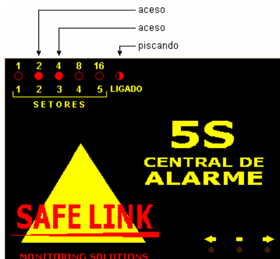
Figura 1.q – central indicando que está no ENDEREÇO 6 (2 + 4 acesos = 6).
