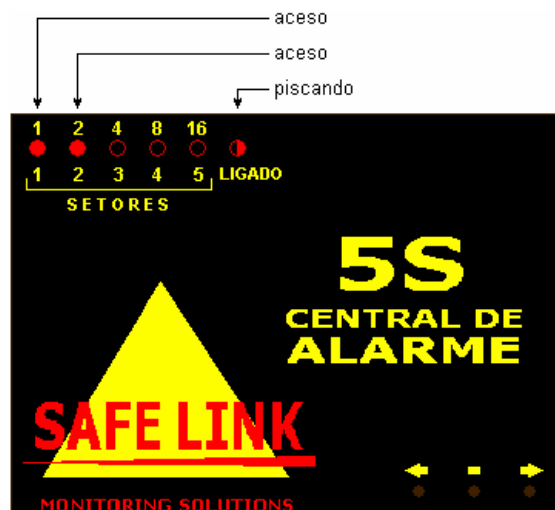
Figura 1.p – central indicando, o valor do QUARTO CAMPO é “3” (1 + 2 acesos = 3).
