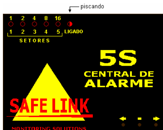
Figura 1.m – central indicando, o valor do PRIMEIRO CAMPO é “0” (todos os led’s apagados).
