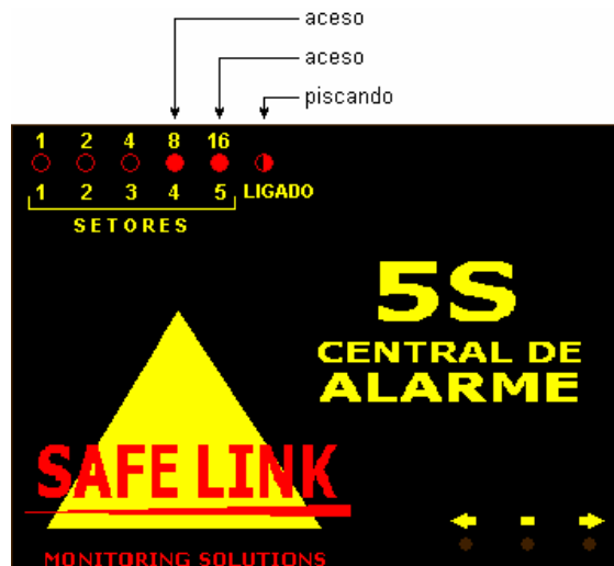
Figura 1.f – central indicando intervalo de auto teste de 24 horas (8 + 16 acesos = 24).
