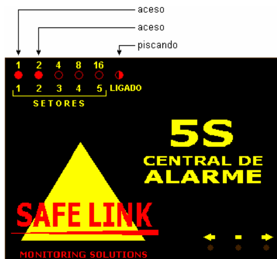
Figura 1.g – central indicando que está no ENDEREÇO 3 (1 + 2 acesos = 3).
