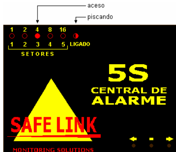
Figura 1.i – central indicando que está no ENDEREÇO 4 .
