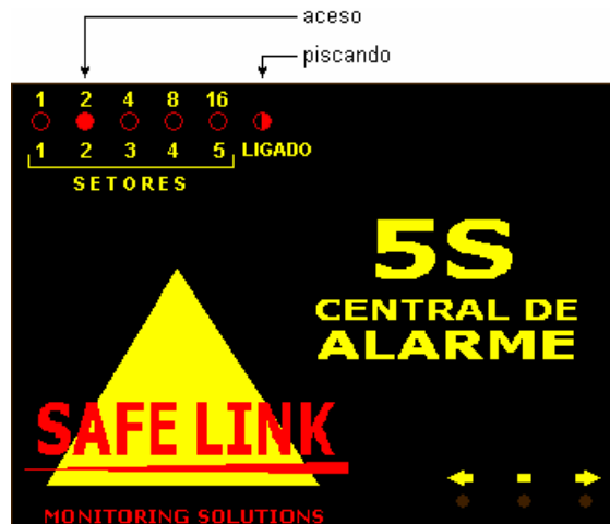
Figura 1.e – central indicando que está no ENDEREÇO 2 .
