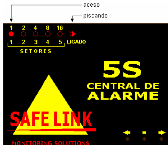
Figura 1.h – central indicando tipo de discagem decádico.
